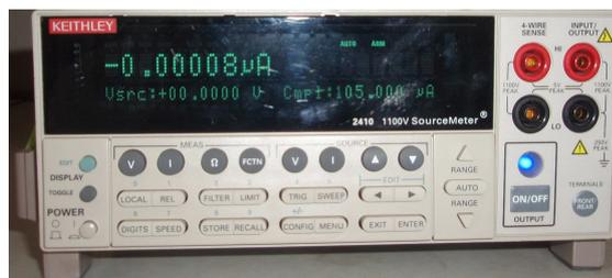
Abbildung 37: Keithley 2410. Das Keithley 2410 liefert maximal 20mA bei einer maximalen Ausgangsspannung von 1100V.
