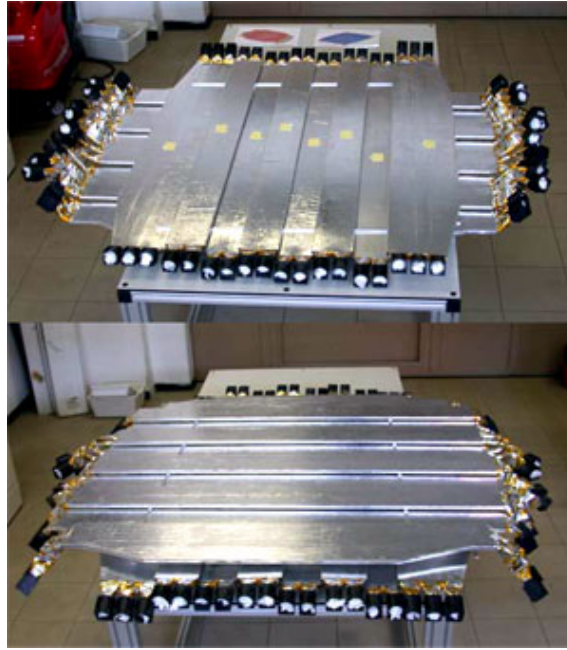
Abbildung 2.7.: Die zwei Platten des Flugzeitdetektors [9].
