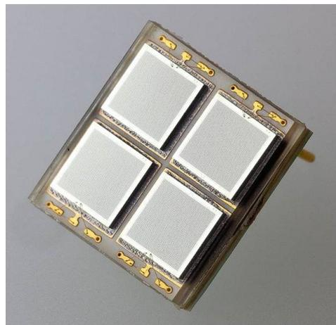
**Abbildung 23: SiPM des Herstellers KETEK [15]**
