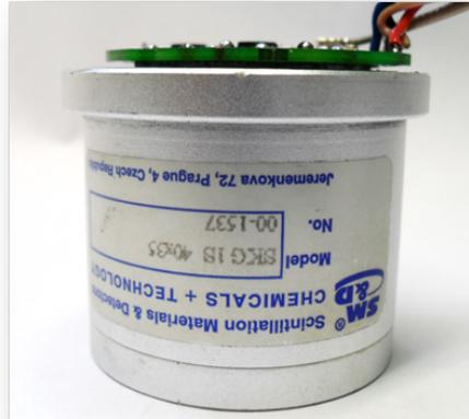
Abbildung 42: Gekapselter Szintillator mit aufliegendem SiPM
