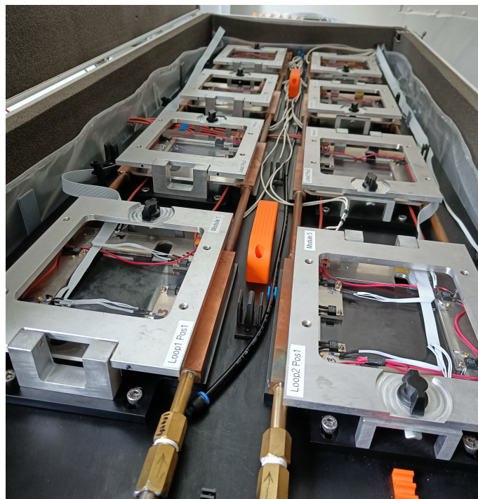
Abbildung 3.2.: Bild des Inneren der Box der Burn-In-Station. Zu sehen sind die Kühlkreisläufe, sowie acht eingelegte Carrier, die mit Heizwiderständen bestückt sind.
