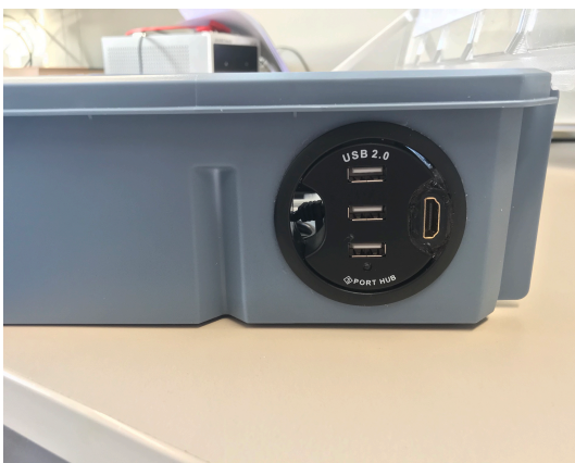
Abbildung D.7.: Herausgeführte USB-Anschlüsse und HDMI-Ausgang
