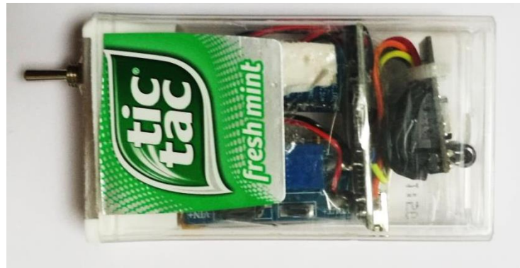
Abb. 7-4: Möglicher Aufbau einer Telemetrie-Box (Quelle: Eigene Darstellung)
