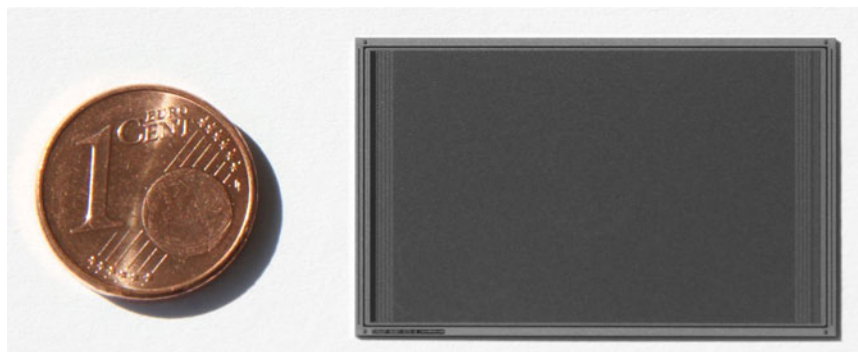
Abbildung 5.1.: Mini-Streifensensor im Größenvergleich mit einem 1 Cent Stück (Durchmesser 16,25\text{ mm} ) (Foto: Reinhard Randoll)
